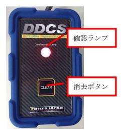
DDCSを正しくバイクへ取り付けた後、Z125 PRO のイグニッションキーを回して、バイクをキーON にします。
