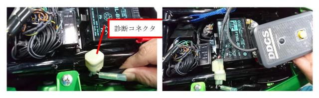
Z125 PRO のシートを外し、診断コネクタのカバーを爪を内側から外側に引っ張りながら外します。 DDCSのコネクタをカチッと音がするまで、Z125 PRO の診断コネクタに取り付けます。
