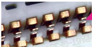
コネクタスロット内部のECU端子をつかむ為の端子が飛び出している。この状態でECUを差し込むと端子が破壊されてしまい重大なトラブルになります。
