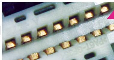
コネクタスロット内部のECU端子をつかむ為の端子が綺麗に引っ込んでいる。(開いている) ECUから飛び出ている基板端子の厚み分が確保されている。
