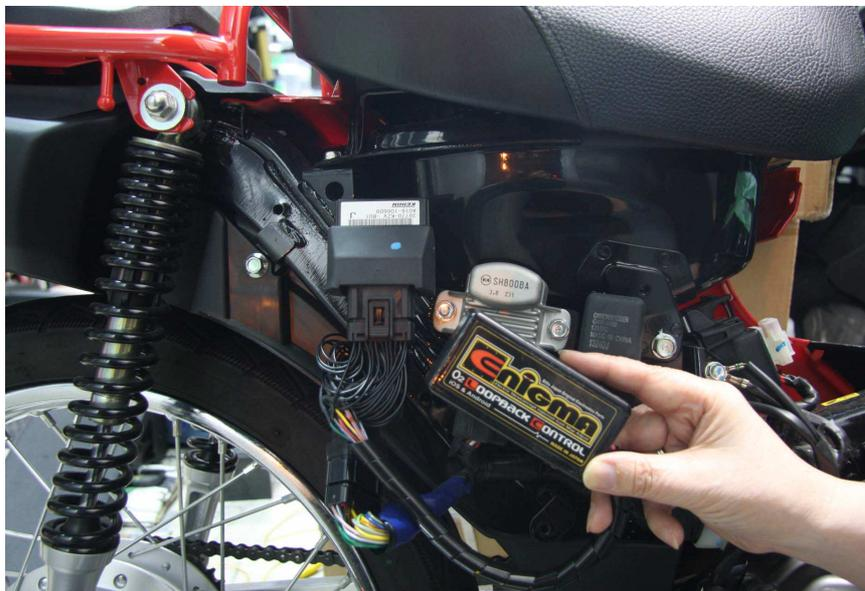
ECUに繋がっているカプラーを外し配線を加工して Enigma LC を割り込みさせて下さい。
