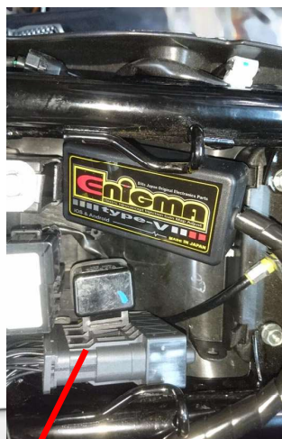
シート下バッテリー後ろのスペースに ECU と ENIGMA を取り付けた例
